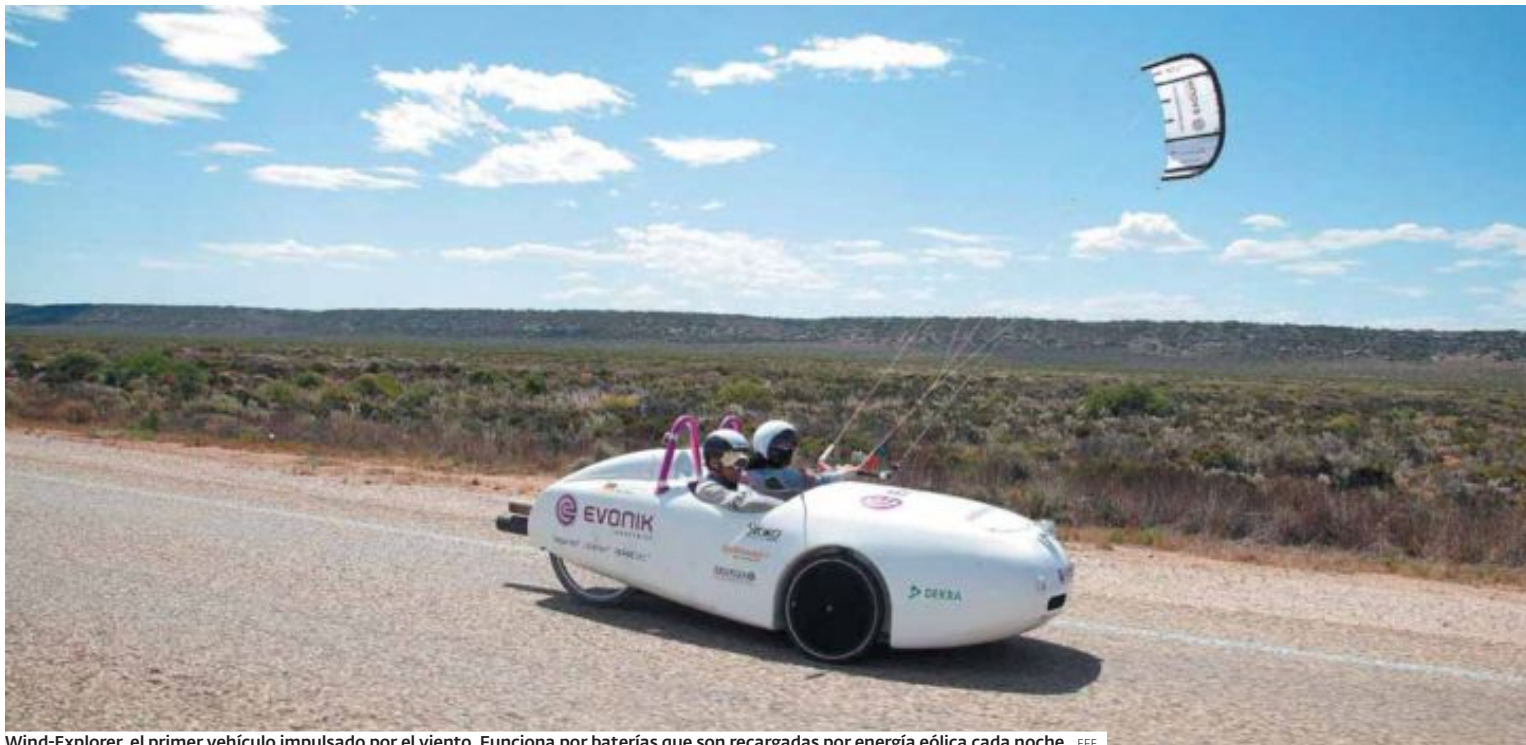
Wind-Explorer, el primer vehículo impulsado por el viento. Funciona por baterías que son recargadas por energía eólica cada noche. EFE.
